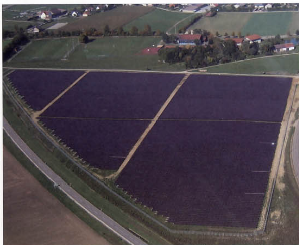
Solarkraftwerk Fünfstetten in Bayern – Silizium-Dünnschichtanlage mit 27 945 Solarmodulen
